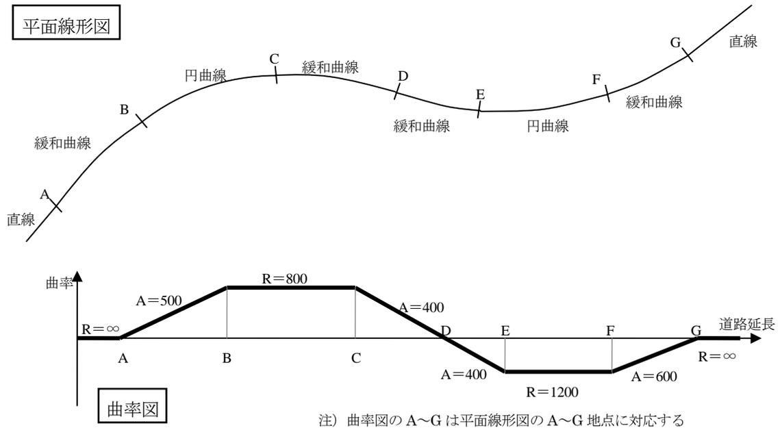
図 3-8 平面線形の曲率図の対応関係
