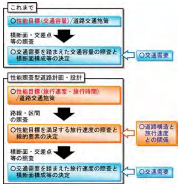
図2-4 道路計画・設計時における性能照査の流れ
